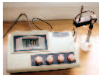
图 3-12 用 \text{pH} 计测量溶液的 \text{pH}
