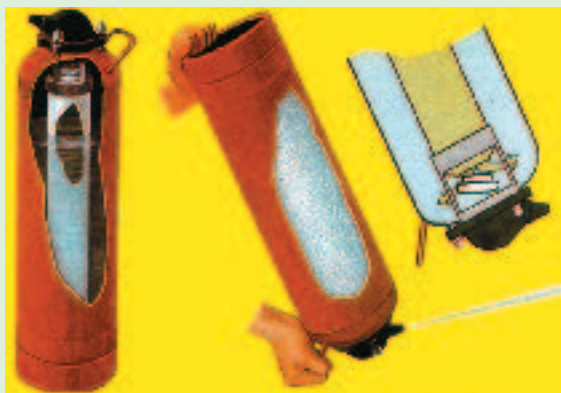
图 3-23 泡沫灭火器的构造和原理示意图
