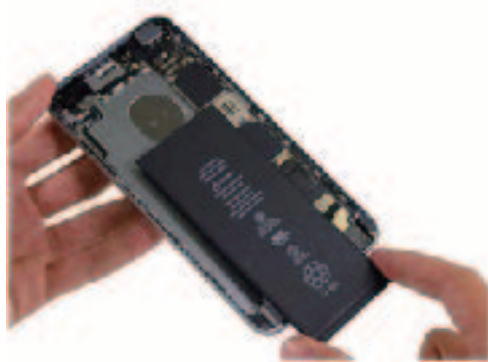
图 1-14 电子设备中常用的锂离子电池
