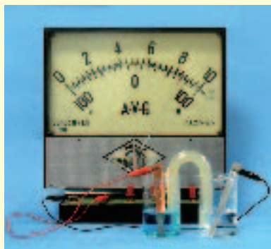
图 1-8 铜锌原电池实验图
